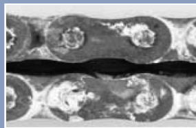
Couche d'alliage zinc-étain Test de jet d'eau saline de 300 heures
